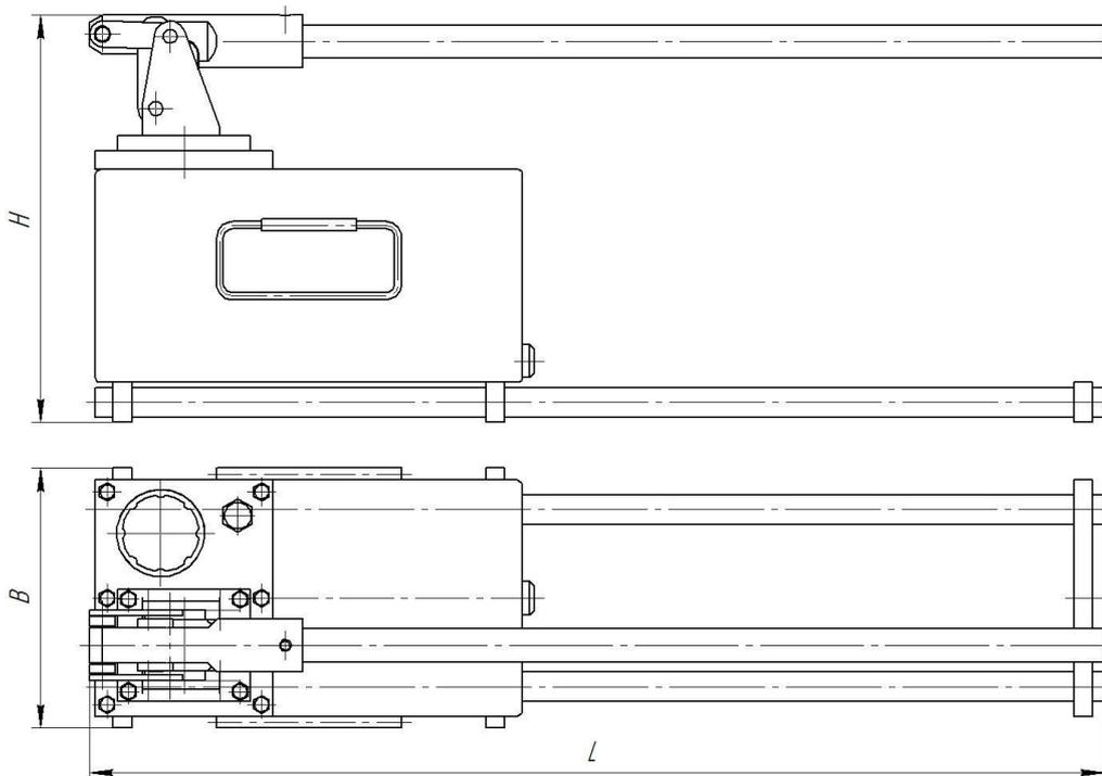
Насосы гидравлические с ручным приводом серии **НРГ** предназначены для обеспечения гидравлической энергией промышленного гидравлического инструмента высокого давления. Модели **НРГ...Р** оснащены распределителем для питания гидроинструмента двойного действия.
