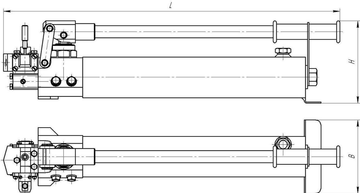
Насосы гидравлические с ручным приводом и распределителем серии **НРГ...Р** предназначены для обеспечения гидравлической энергией промышленного гидравлического инструмента высокого давления. Присоединительная резьба – К 3/8" ГОСТ 6111-52.
