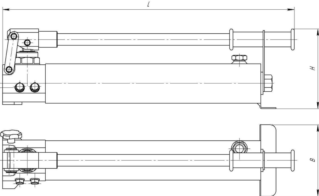
Насосы гидравлические с ручным приводом серии **НРГ** предназначены для обеспечения гидравлической энергией промышленного гидравлического инструмента высокого давления.
